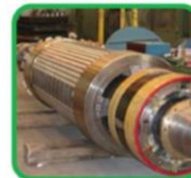
Неявнополюсный ротор, с сердечником состоящими из пластин электротехнической стали. Без отверстия для вентиляции обмотки и доп. креплений (вариант турбины).
