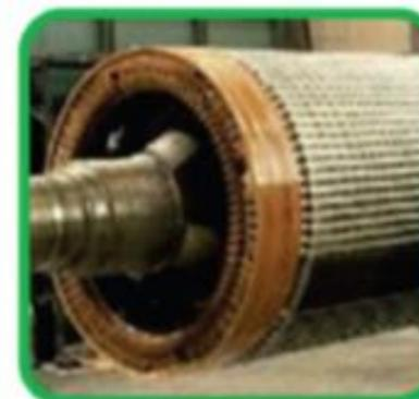
Неявнополюсный ротор, с сердечником состоящими из пластин электротехнической стали. Имеются специальные отверстия для вентиляции обмотки и доп. креплений.
