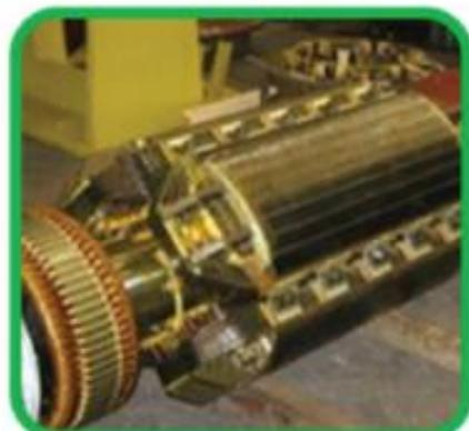
Явнополюсный ротор, состоящий из набора пластин электротехнической стали в форме звезды (сердечник совместно с полюсами)
