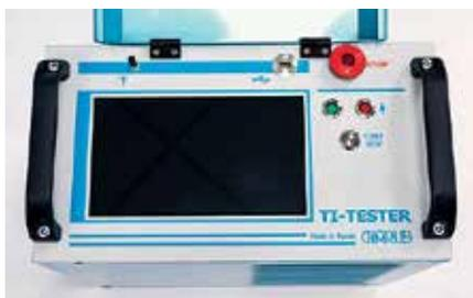
Рис. 2. Прибор TI-Tester для контроля состояния высоковольтных вводов силовых трансформаторов
