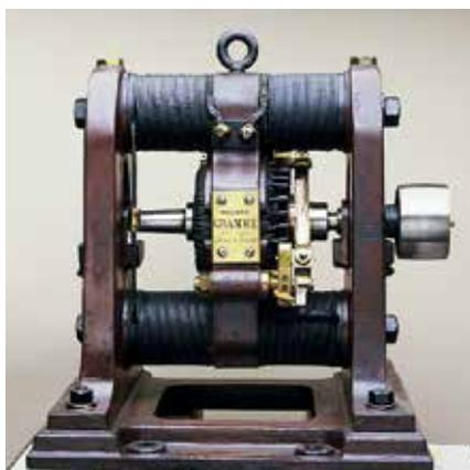
Рис. 1. Электрическая машина Грамма
