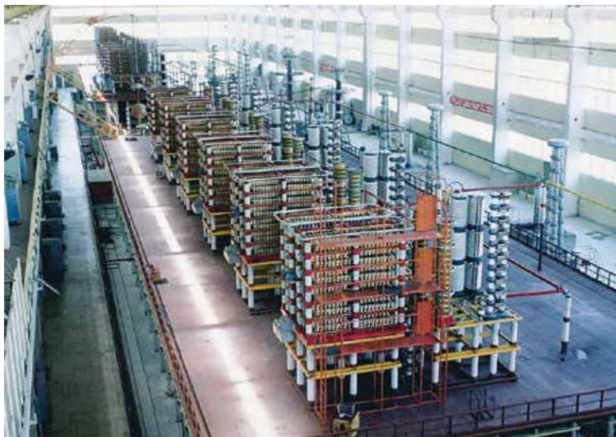
Рис. 4. Стенд испытаний тиристорных блоков напряжением 375 кВ
