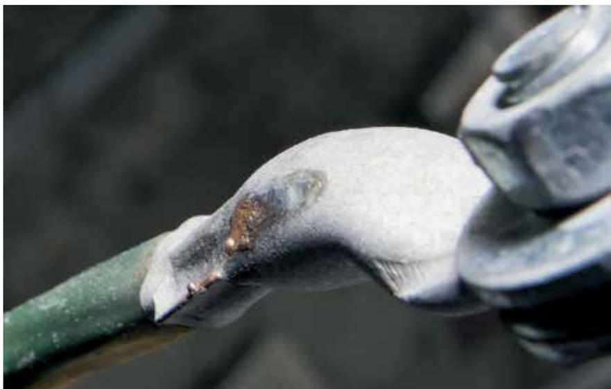
Фото 10. След дугового замыкания с повреждённой обмотки на шлейфы разрядников
