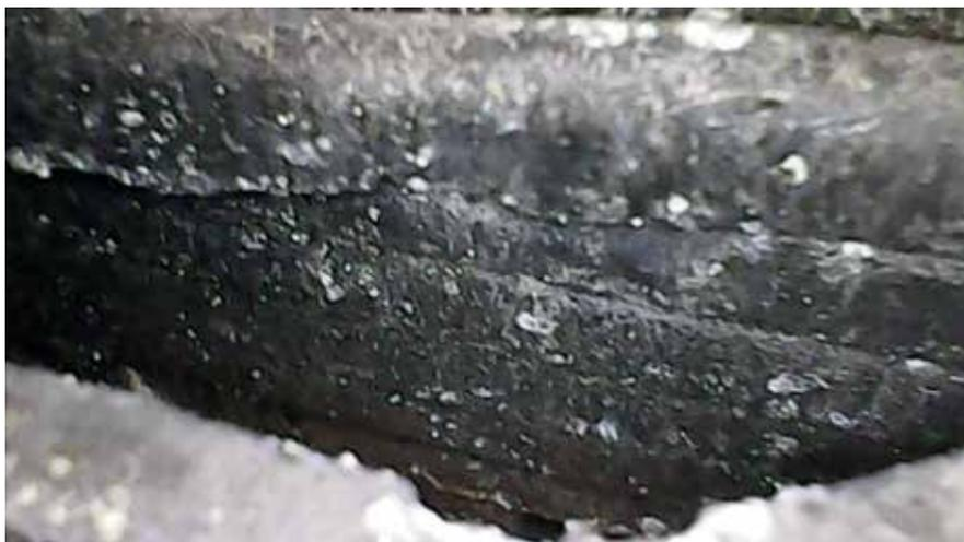
Фото 9. Повреждение внутри TOP (снято электронным эндоскопом)
