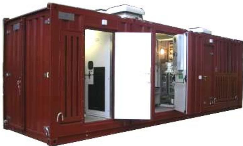
**Вариант изготовления преобразователя в контейнере**
